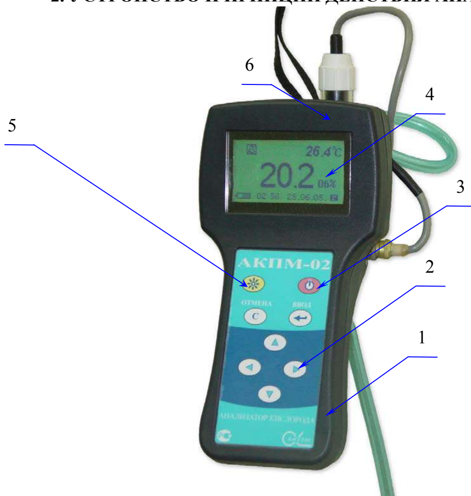
Рис. 2.1. Внешний вид анализатора кислорода АКПМ-1-02 (лицевая сторона).
